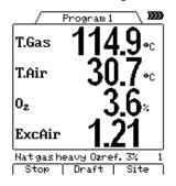
В верхней линии, индицируется выбранная программа измерения, в строке состояния указывается тип топлива со значением нормированного О2. В левом углу индицируется номер текущей страницы.
