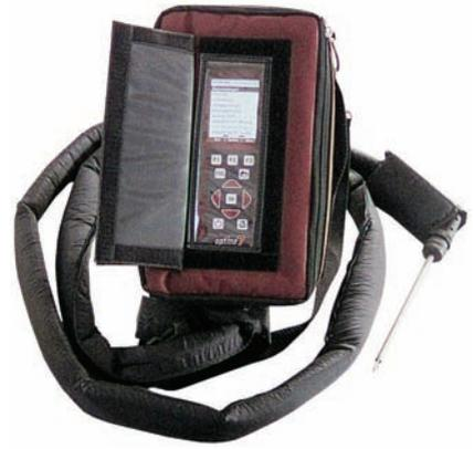
Газоанализатор Optima 7 с зондом в обогреваемом термочехле для работы на морозе до  $-30$  °С
